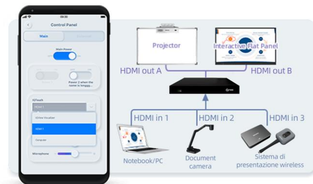
Cambio sorgenti d'ingresso
